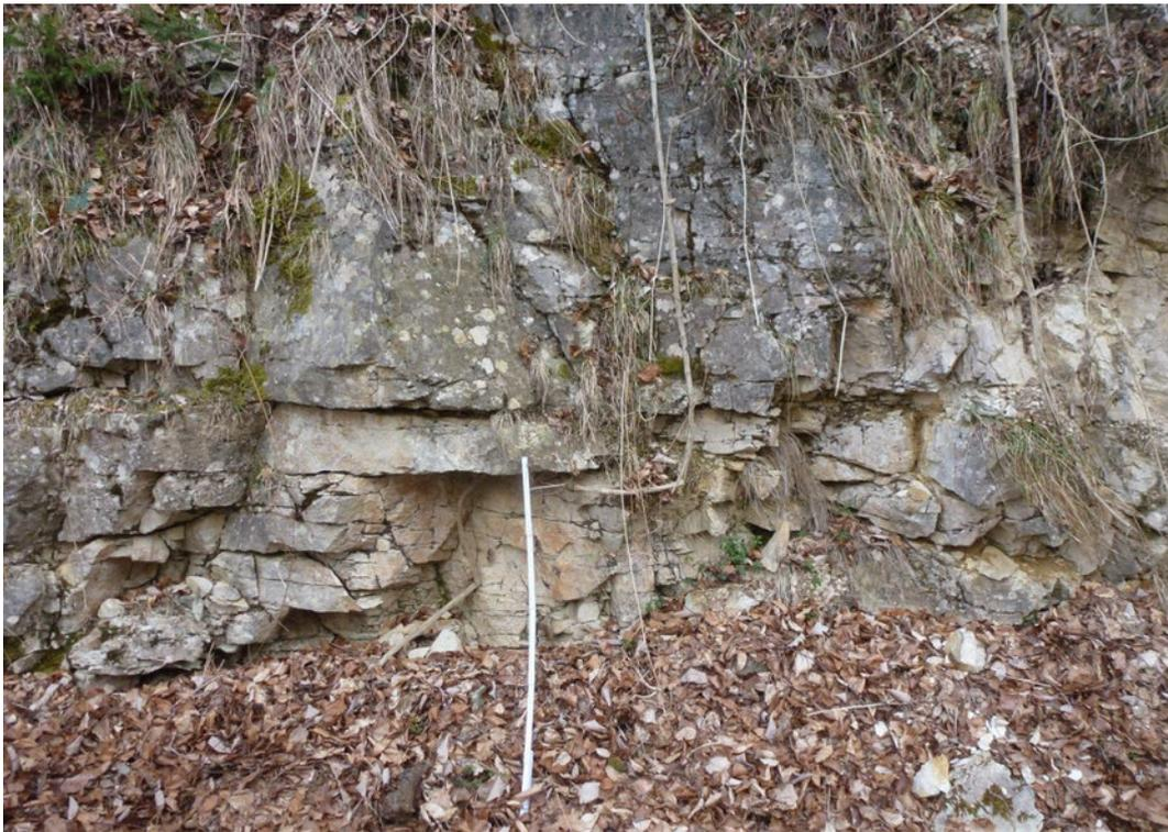
Figura 8.6: Ammasso in corrispondenza alla stazione geomeccanica, in basso la fascia più fratturata (GSI medio 50), sopra quella più massiva (GSI medio 60)
